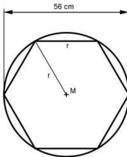
Der Radius des Baumstamms entspricht dem Umkreisradius und einer Seitenlänge  $s$  des Sechsecks.
